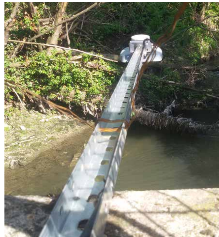
■ Uno dei sensori Angel River installato sul corso del fiume Lambro
